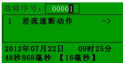
光标位于故障序号框中，故障序号为最新的故障序号，按“+”和“-”键可以依次查看故障报告。
