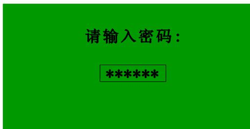
密码最大位数为 6 位，有四个方向键组成。输入完成后按“确认”键，如果密码错误，弹出对话框，提示用户密码不正确并返回到定值修改界面。如果密码正确，弹出对话框，提示用户定值存储成功。
