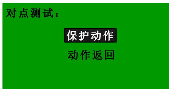
在对话框中，按“↑”和“↓”分别向上和向下移动光标选择保护动作和动作返回，选中后按确认键即可完成一次对点测试。
