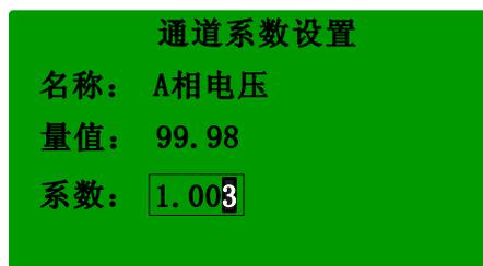
在系数修改框中，按“+”和“-”键修改相应的数值。系数修改过程中，量值随系数的变化而实时变化，当量值调整到满足误差要求时按确认键装置弹出对话框提示系数修改成功。
