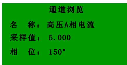
所有通道的相位均为相对于 A 相电压的相位，当 A 相电压小于无压门槛时，所有通道的相位为 0~360 之间的随机值。
