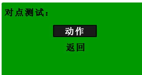
在对话框中，按“↑”和“↓”分别向上和向下移动光标选择动作和返回，选中后按确认键即可完成一次对点测试。
