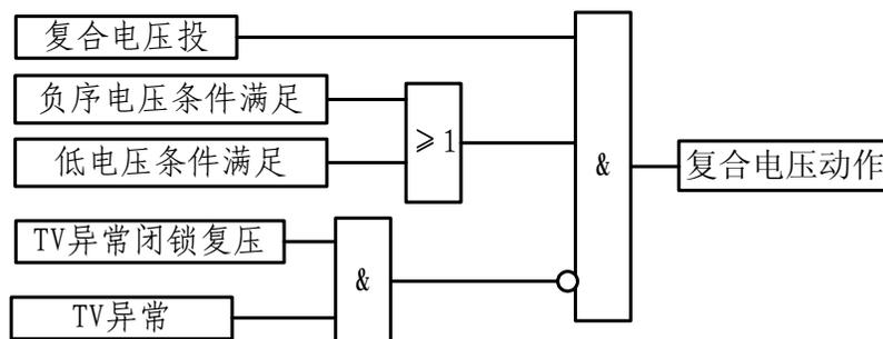
图 4-6 复合电压逻辑图
