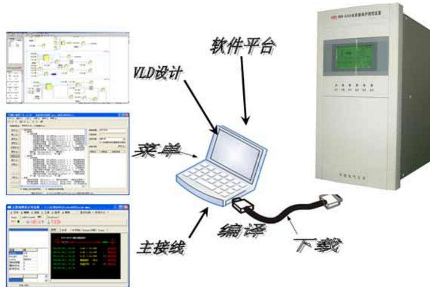
图 4-1: 装置功能实现方式示意图
