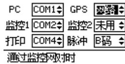
图 5-11 通信端口子菜单示例
