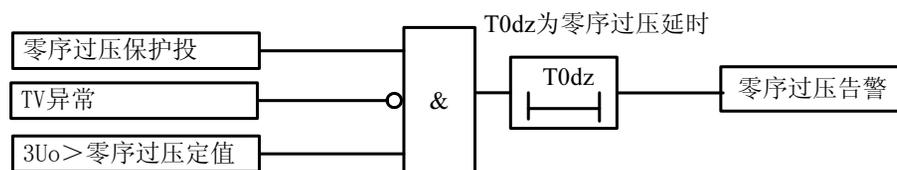
图 4-7 零序过压保护逻辑
