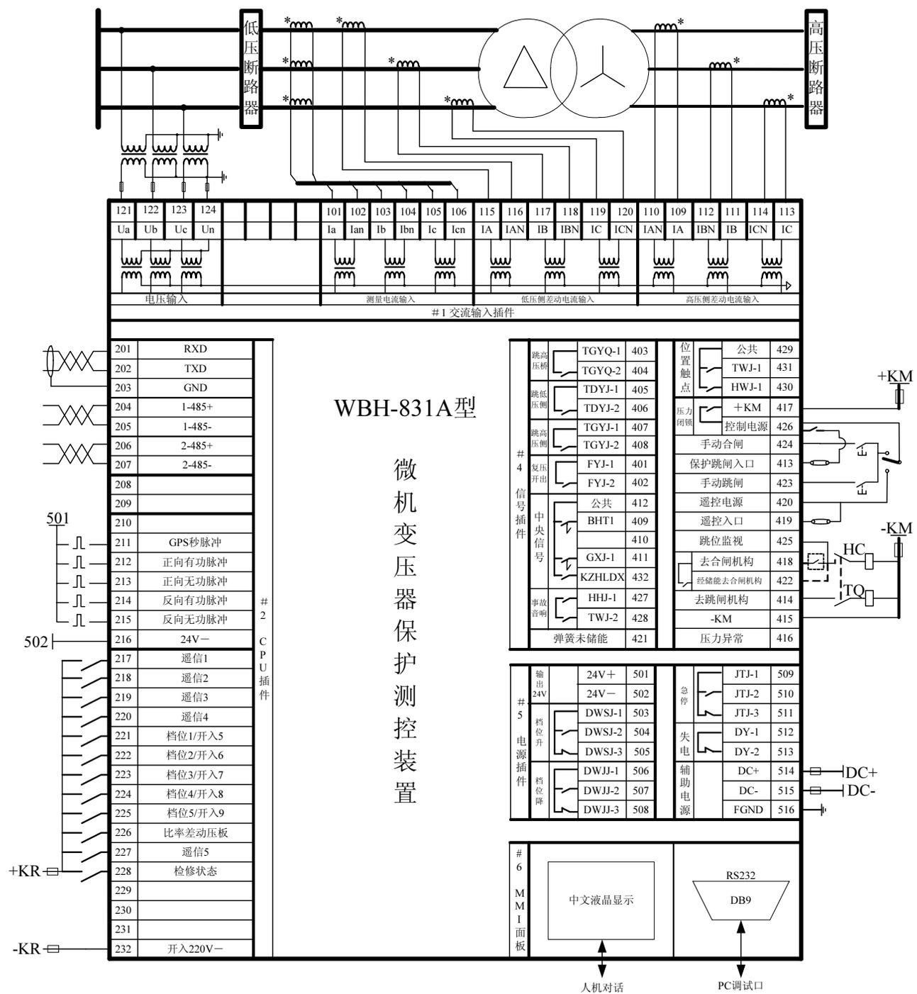
图 12-1 WBH-831A 装置接线示例图
